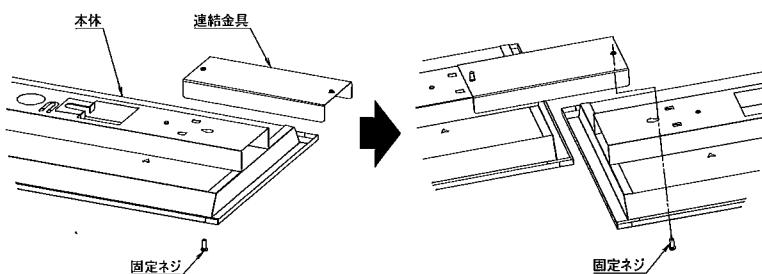
△ 取付部の強度が不十分な場合、埋込穴寸法が大きい場合は、器具落下・光モレの原因となります。
