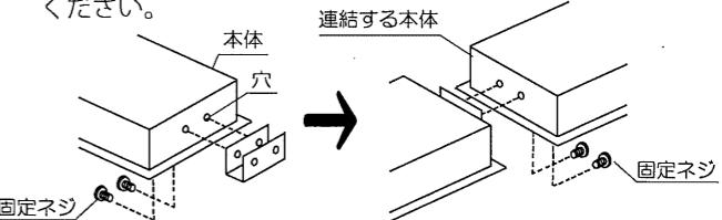
△ 取付けが不十分な場合、埋込穴寸法より大きい場合は、器具落下・光モレの原因となります。
