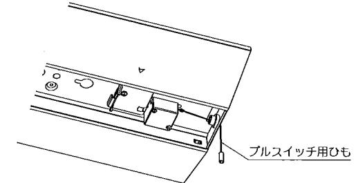
5. 内部配線にて、電源線を通す場合は、線押さえを使用して電源線を固定してください。
