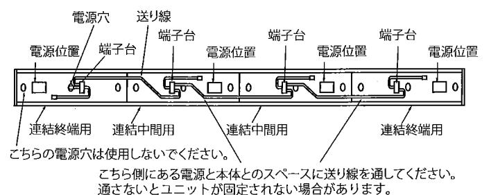
3. 電源線を電源用端子台に接続してください。
