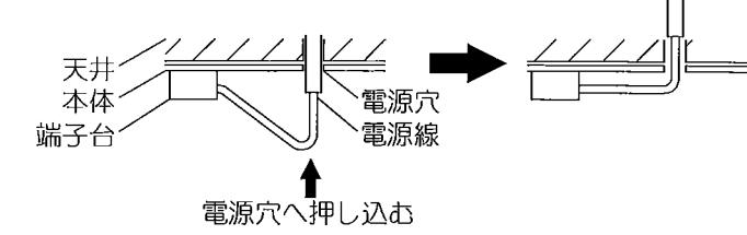
4. 内部配線にて、電源線を通す場合は、線押さえを使用して電源線を固定してください。
