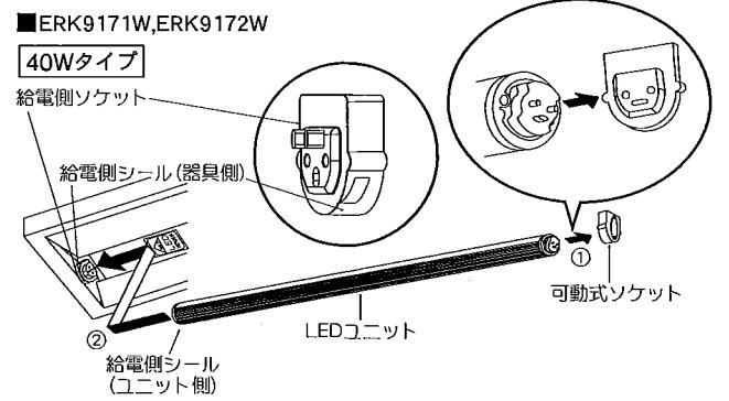
6. オプティカルチューブユニットは器具取付後ユニットを回転させる事により照射方向が調整できます。
