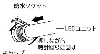
△ 接続不完全や取付け方向が反対の場合、火災・感電・
