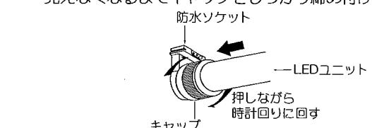
△ 接続不完全や取付け方向が反対の場合、火災・感電・器具故障の原因となります。
