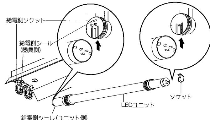
●LEDユニットを差し込み後、両端のソケットのゴムリングが見えなくなるまでキャップをしっかりと締め付けてください。
