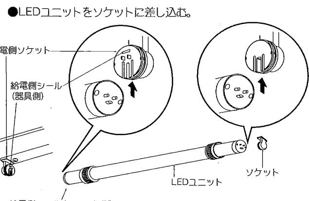
● LEDユニットを差し込み後、両端のソケットのゴムリングが見えなくなるまでキヤップをしっかりと締め付けてください。
