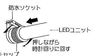
△ 接続不完全や取付け方向が反対の場合、火災・感電・器具故障の原因となります。
