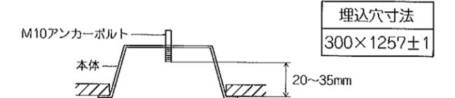
△ 取付部の強度が不十分な場合、上記埋込穴寸法より大きい場合は、器具落下・光モレの原因となります。
