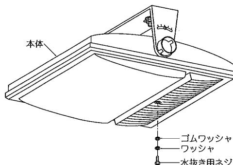
△ 水抜き穴を必ず確保してください。漏電・感電・器具故障の原因となります。
