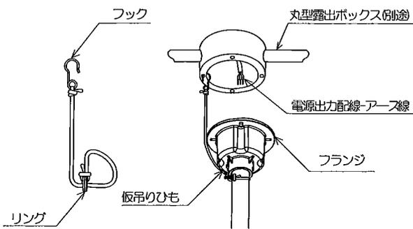
4. 電源出力配線とリード線を丸型露出ボックス内またはフランジ内にて結線してください。
