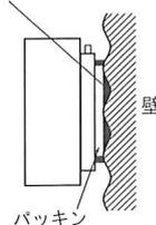
⚠ 取付面の凹凸によりすき間が生じた場合、漏電の原因となります。取り付け面とパッキンの間をコーキング処理してください。
