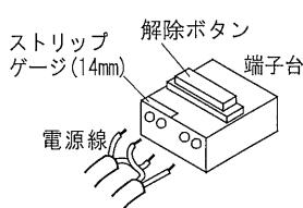
※電源線はストリップゲージに合わせて剥いてください。
