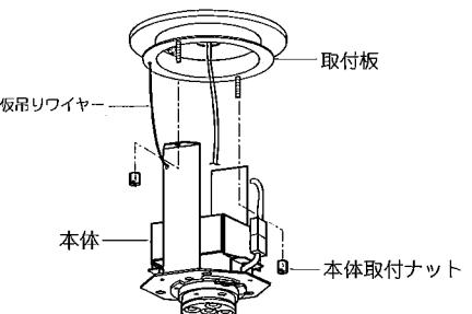
△ 取付けが不十分な場合、器具落下・火災・漏電の原因となります。
