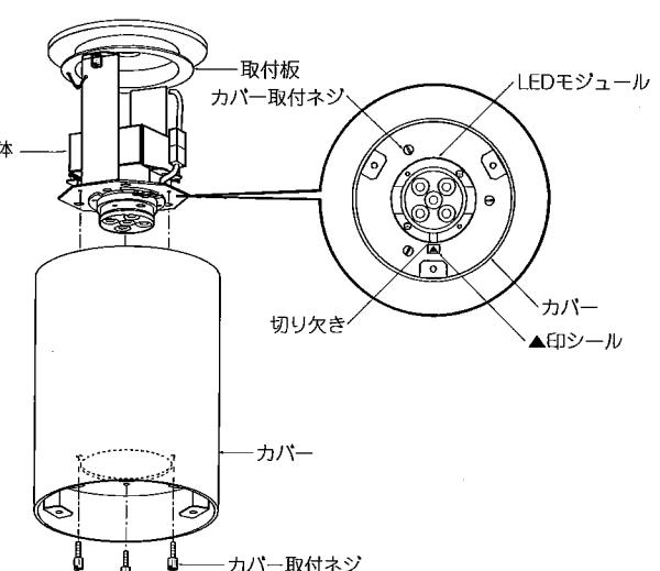
△ 取付けが不十分な場合、カバー落下・火災・漏電の原因となります。
