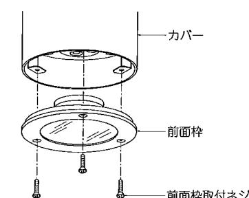
△ 取付けが不十分な場合、前面枠落下・火災・漏電の原因となります。
