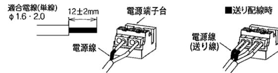
△ 電源線は解除ボタンを押さずに引き抜かないでください。接点金具が変形し、焼損、漏電、感電、不点灯の原因となります。
