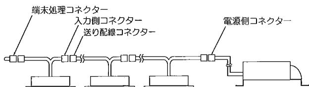
端末灯体の送り配線には端末処理コネクターを確実に差し込み接続してください。
