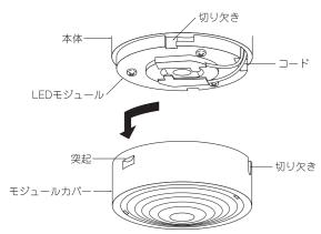
4. モジュール固定ネジ(3個)をゆるめてLEDモジュールを本体から取りはずしてください。
