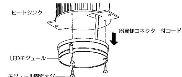
6. 新しいLEDモジュールの器具側コネクター付コードをヒートシンクに通してから、LEDモジュールをヒートシンクに合わせて、LEDモジュール固定ネジ(3個)を締め付けて固定してください。
