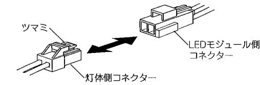
5. モジュール固定ネジ(3個)をゆるめて、LEDモジュールをヒートシンクから取りはずし、器具側コネクター付コードをヒートシンクから引き抜いてください。
