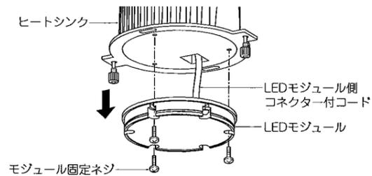
6. 新しいLEDモジュールのLEDモジュール側コネクタ付コードをヒートシンクに通してから、LEDモジュールをヒートシンクに合わせて、LEDモジュール固定ネジ(3個)を締め付けて固定してください。
