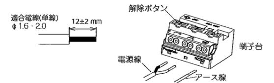
△ 電源線は解除ボタンを押さずに引き抜かないでください。→接点金具が変形し、焼損の原因となります。
