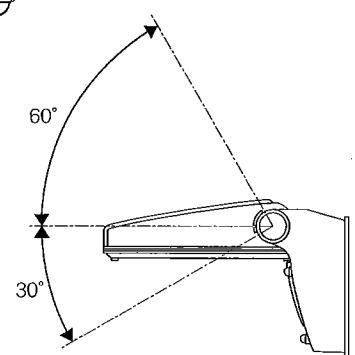
△ 指定範囲以外可動させないでください。破損・落下・感電の原因となります。
