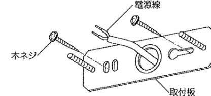
⚠ 取付けが不十分な場合、器具落下・火災・漏電の原因となります。
