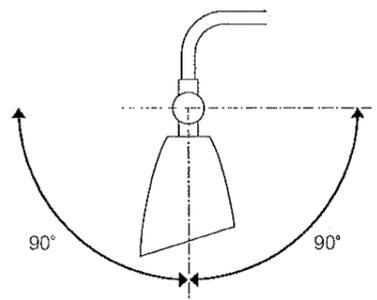
⚠ 指定範囲以外可動させないでください。破損・落下・感電の原因となります。
