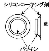
**⚠ 取付面の凹凸により、すき間が生じた場合、漏電の原因となります。取付面とパッキンの間に必ずコーティング処理してください。**
