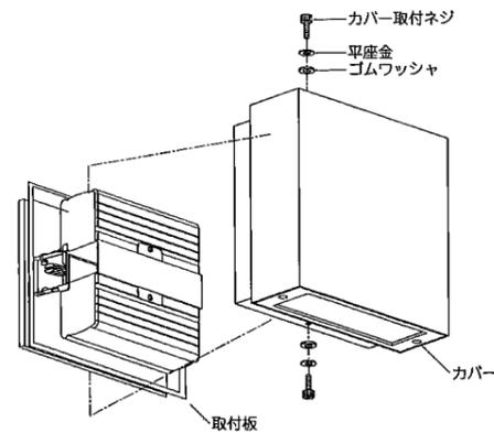
3. 灯体の左側の灯体固定ネジをゆるめ、取付板のガイド(左側)の切り欠きからはずし、灯体の右側のツメを取付板のガイド(右側)から抜いて灯体を取りはずしてください。
