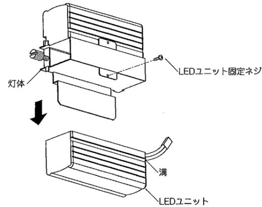
6. 新しいLEDユニットを灯体に合わせ、LEDユニット固定ネジ(2本)をLEDユニットの溝に合うように確実に締め付けて固定してください。
