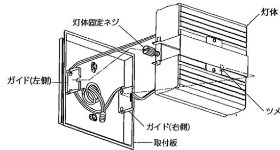
8. カバーを取付板に合わせ、取付面に押し付けながら、ゴムワッシャ(2枚)、平座金(2枚)、カバー取付ネジ(2本)で確実に取付けてください。
