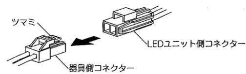
5. 灯体のLEDユニット固定ネジ(2本)をゆるめ、LEDユニットを灯体から取りはずしてください。
