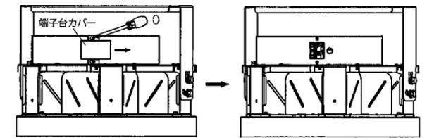
4. 電源線を電源用端子台に接続してください。
