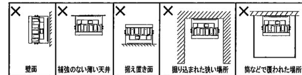
△ 指定範囲以外可動させないでください。破損・落下・感電の原因となります。
