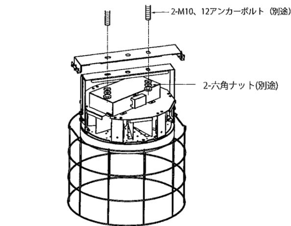
2. 天板とガードを取付けて(図①)、ローレットビス (4個) で固定してください(図②)。
