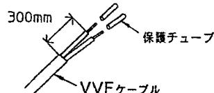
4. 電源線を端子台に保護カバーを付けた状態で接続してください。
