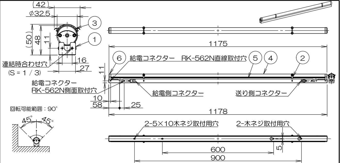
最小施工寸法 ※熱的な限度寸法になります。施工のしやすさ・光の伸びは考慮されていません。
