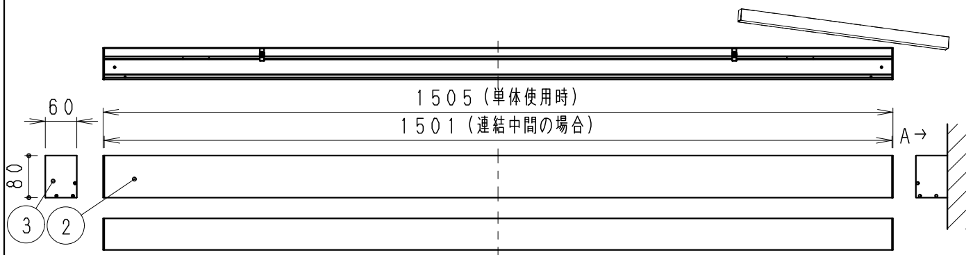
取付寸法図 (A 矢視図)
