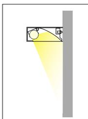
LEDZチューブユニットを光源としたスリムでシンプルなウォールウォッシャーブラケットです。壁面照射に最適な器具設計を追求し、効率的で均一な鉛直面配光をコンパクトサイズで実現しました。上向き配光としてもお使いいただけます。
