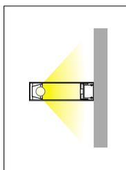
LEDユニットの細さを活用したスリムな間接ブラケットです。光源が直接視線に入る事がなく、やわらかく壁面を照らします。サンタリー洗面まわりや階段室など間接照明手法による演出ができます。天井面取付けによるアッパーライト演出としての使い方も可能です。
