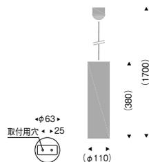
eco 省エネ | ハンドメイド | LEDランプ: RAD-427L (E17) | 電球色 (2700K) | Ra80 | 固有エネルギー消費効率 65.6 lm/W (328 lm)
