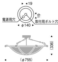
LEDランプ:RAD-427L (E17) 電球色 (2700K) 固有エネルギー消費効率 70.0lm/W(2100lm)
