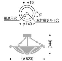
LEDランプ:RAD-427L (E17) 電球色 (2700K) 固有エネルギー消費効率 70.0lm/W(1750lm)
