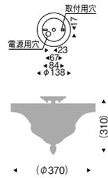
LEDランプ:RAD-425L (E17) 電球色 (2700K) 固有エネルギー消費効率 75.8lm/W(758lm)
