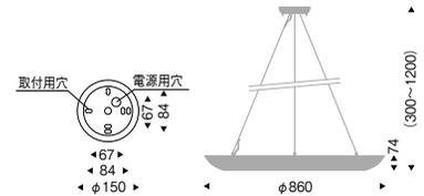
eco green | eco 省エネ | LEDランプ:RAD-427L (E17) 電球色 (2700K) Ra80 75.7lm/W(3031lm) 固有エネルギー消費効率
