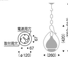
eco 省エネ | ハンドメイド | LEDランプ: RAD-428L (E17) | 電球色 (2700K) | Ra80 | 固有エネルギー消費効率 70.0lm/W(350lm)
