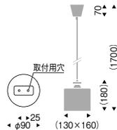
eco green | ハンドメイド | LEDランプ:RAD-427L(E17) | 電球色(2700K) | Ra80 | 固有エネルギー消費効率 81.2lm/w(406lm)
