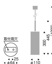
eco green LEDランプ:R7000B(E26) 固有エネルギー消費効率 82.0 lm/W(402 lm) 電球色(2700K) Ra82
