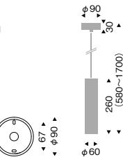
eco ハンドメイド LEDランプ:RAD-427L(E17) 固有エネルギー消費効率 65.6 lm/W(328 lm) 電球色(2700K) Ra80
