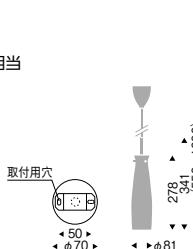
eco ハンドメイド LEDランプ:RAD-427L(E17) 固有エネルギー消費効率 59.6 lm/W(298 lm) 電球色(2700K) Ra80
