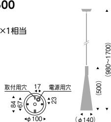
eco ハンドメイド LEDランプ:RAD-427L(E17) 固有エネルギー消費効率 59.6 lm/W(298 lm) 電球色(2700K) Ra80
