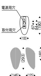
**eco** 省エネ LEDランプ:RAD-427L(E17) 固有エネルギー消費効率 Ra80 電球色(2700K) 59.6 lm/W(298 lm)
