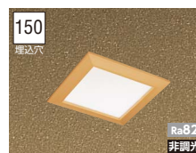
ERD3283N ¥16,500 LEDランプ×1 図<100V> ● 白熱球40W形×1器具相当 消費電力: 4.9W 56.3 lm/W(276 lm) 径□190mm 重:1.1kg
