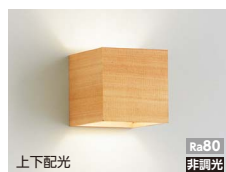
ERB6297N ¥14,500 LEDランプ×1 図<100V> ● フロストクリプトン球40W形×1相当 消費電力: 5.0W 65.6 lm/W(328 lm) 巾□100 出100mm 重:0.3kg
