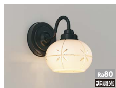
ERB6436W ¥25,500 LEDランプ×1 図<100V> ● 透明クリプトン球40W形×1相当 消費電力: 5.0W 46.0 lm/W(230 lm) 巾φ150 高(180) 出(215)mm 重:0.7kg
