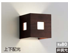
ERB6299N ¥15,500 LEDランプ×1 図<100V> ● フロストクリプトン球40W形×1相当 消費電力: 5.0W 59.6 lm/W(298 lm) 巾□110 出110mm 重:0.4kg
