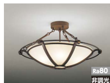
ERG5270X ¥68,000 LEDランプ×5 調 <100V> ● フロストクリプトン球40W形×5相当 消費電力：25.0W 70.0 lm/W(1750 lm) 径(φ623) 高(344)mm 重:7.5kg
