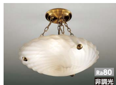
ERG5258M ¥38,500 LEDランプ×5 調 <100V> ● フロストクリプトン球40W形×5相当 消費電力：25.0W 70.0 lm/W(1750 lm) 径(φ495) 高(310~395)mm 重:4.8kg
